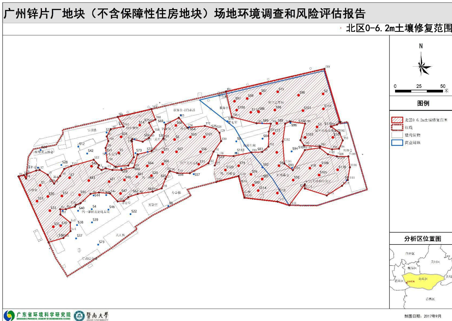
图3.2-5 北区土壤不同深度修复范围汇总图
