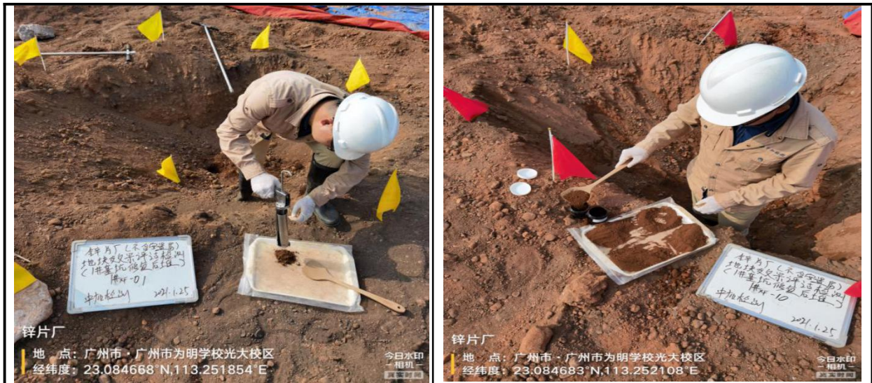
图 6.1-4 1#基坑（1#-1 区~1#-12 区及 1#-14 区）污染土修复后土堆采样图
