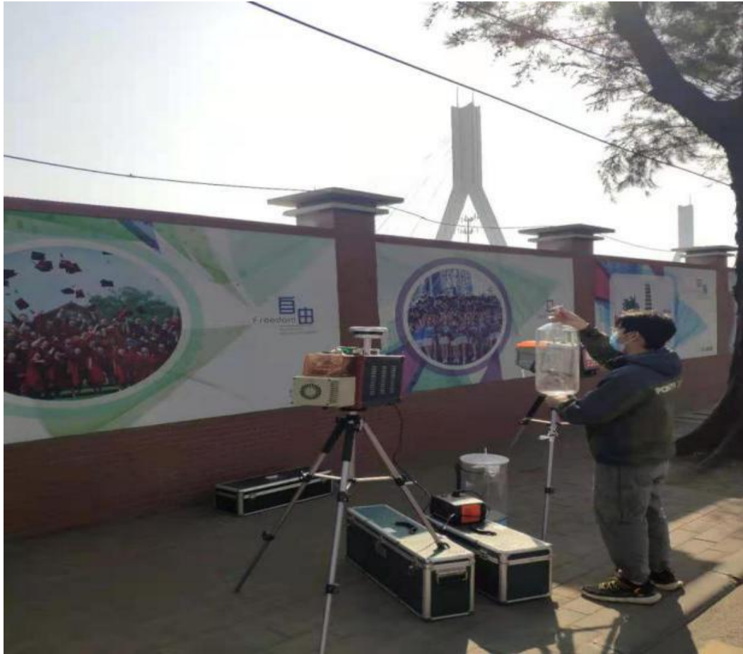
图 3.5-20 厂界无组织现场采样
