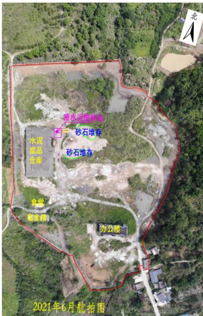
图 3.4-2 临时水泥搅拌站时期平面布置图
